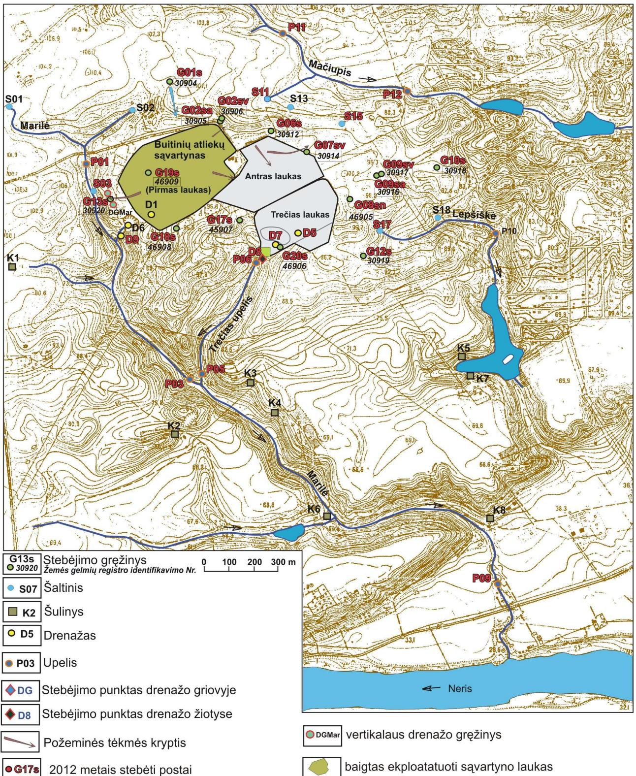
1 pav. Lapių savartyno hidromonitoringo postų schema
